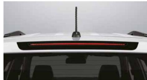
Luce di arresto centrale a LED montata in alto
