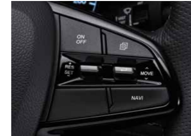
Interruttori del cruise control montati sul volante
